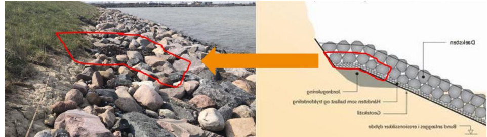
Figur 4.1: Skråningsbeskyttelsen bør udbygges med ralnuderlag og mindst et dækstenlag, der sammen hæver nuværende sten-topkote med ca. 1 meter og udvider slash-zonen med mindst 3 sten i toppen.
