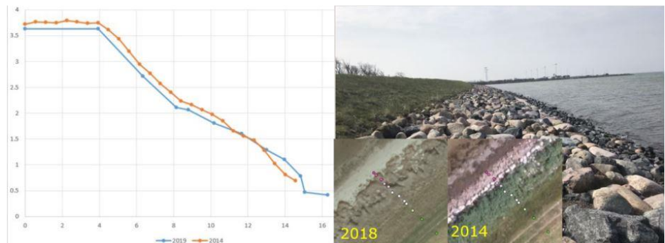
Figur 3.9: Tværsnit E med hele digets havværts side og skråningsbeskyttelsen. Digets topkote er +3,6 m DVR90 i 2019 og digets hældning er 1:2,8, mens skråningsbeskyttelsen starter i +2,1 m DVR90 og har hældningen 1:5,5.
